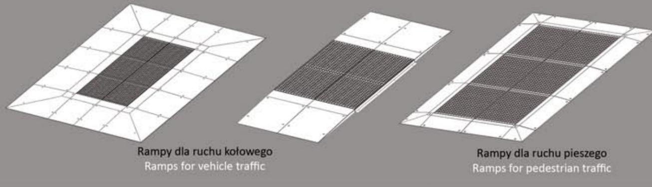
Przy tej formie montażu stosuje się ramę zabezpieczającą posadzkę przed zniszczeniem oraz kątownik boczny w przypadku zastosowania wyłącznie ramp czołowych.
