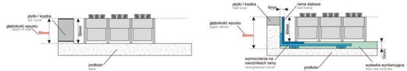
Przy tej formie montażu stosuje się ramę wpustową oraz ramę zabezpieczającą posadzkę pod kratownicą przed zniszczeniem.
